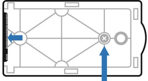
Schraube zur Befestigung der SSD.
